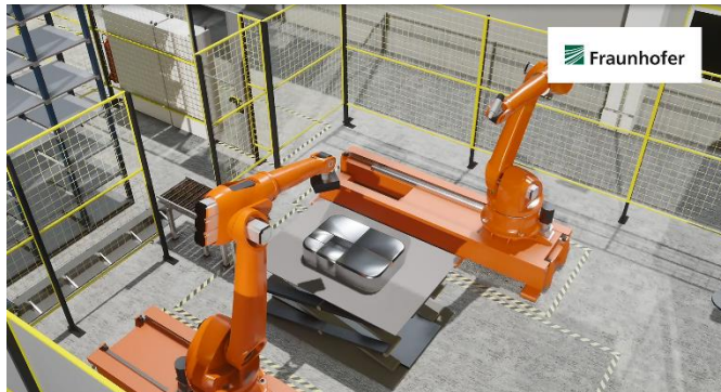
Abb. 2 SWAP ermöglicht die Herstellung großer Bauteile mittels kleiner Standardmaschinen bzw. einer mobilen Maschine fürs Finish © Fraunhofer
