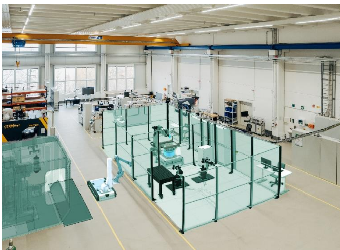
Abb. 1 Matrix-Architektur am IWU-Standort Dresden (Pforzheimer Straße): flexibel beplanbare Fertigungszellen. Das Versuchsfeld ist real aufgebaut; der digitale Zwilling ermöglicht Variantenuntersuchungen und -optimierungen (hier visualisiert im Rendering) © Fraunhofer IWU
